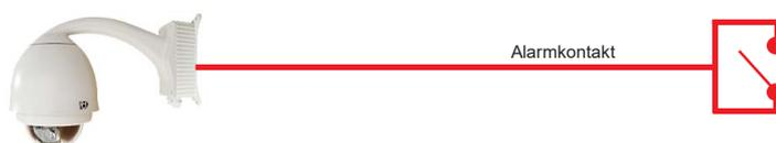
Bei Auslösung eines Alarms durch Bewegungserkennung oder Alarmkontakt können automatisch Videofilme auf dem optionalen FTP Server gespeichert werden. Auch der Versand von e-Mails mit Videofilmmanhang (15Sek.) ist möglich.
